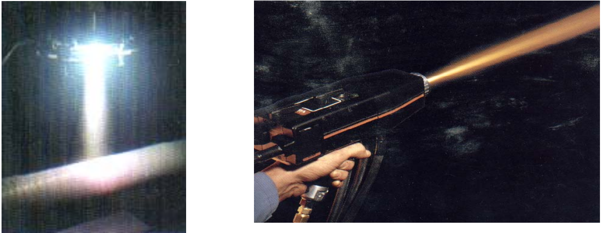
Рис.2 Напыление алюмокерамического покрытия; а – плазменное напыление в заводских условиях, б – электродуговое сверхзвуковое напыление
