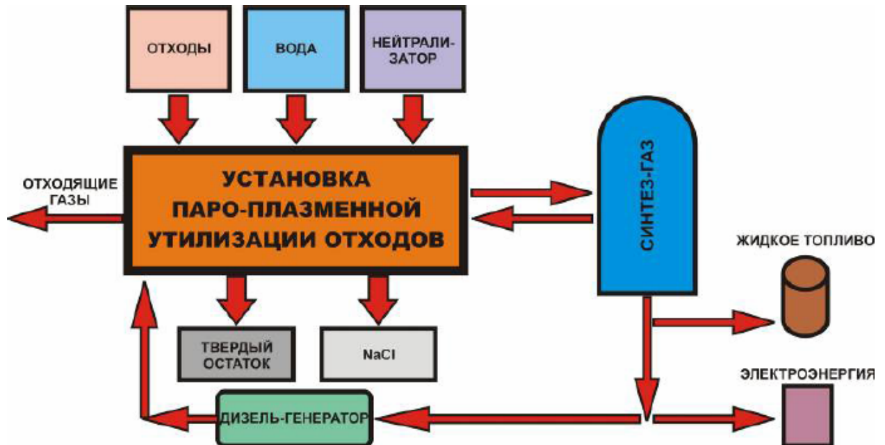
Рис.1 Схема процесса пароплазменной переработки отходов
