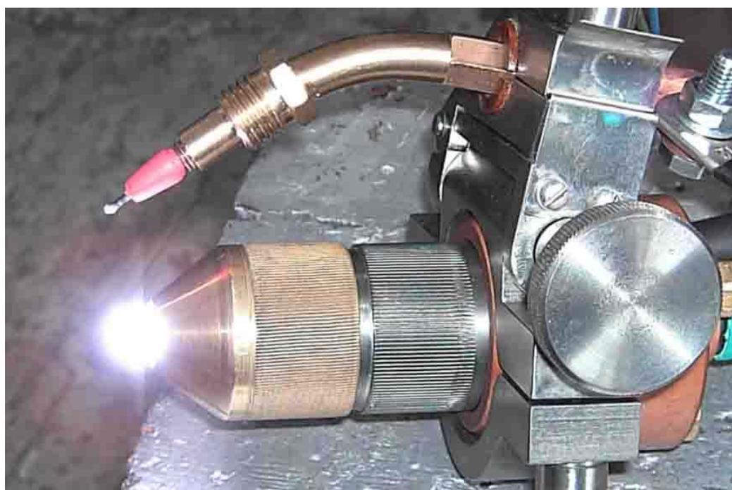
Рис.8 Плазматрон для напыления покрытий на оси.
