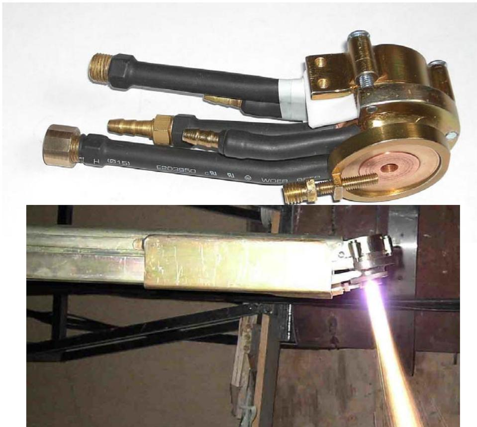
Рис.5. Плазмотрон для напыления внутренних покрытий
