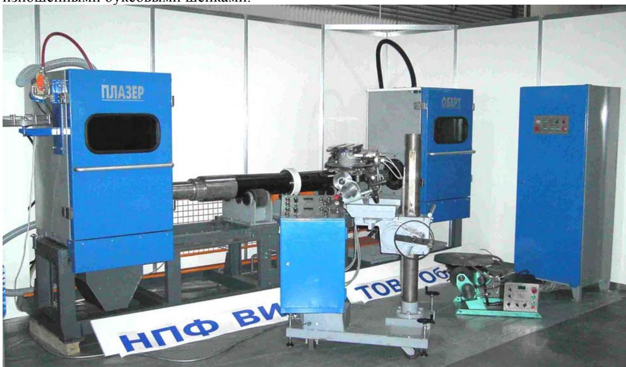
Рис.7. Полуавтоматическая линия для восстановления осей с изношенными буксовыми шейками.
