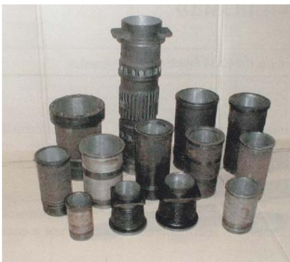
Рис.6. Цилиндрические втулки с плазменным покрытием
