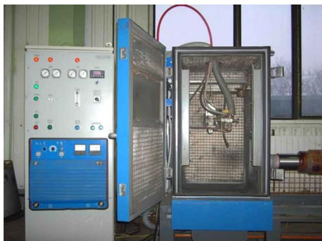
Рис.3. Полуавтомат «ПЛАЗЕР» для реновации осей колесных пар
