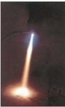
Рис. 2. Напыление никромового порошка в сверхзвуковой плазменной струе.
