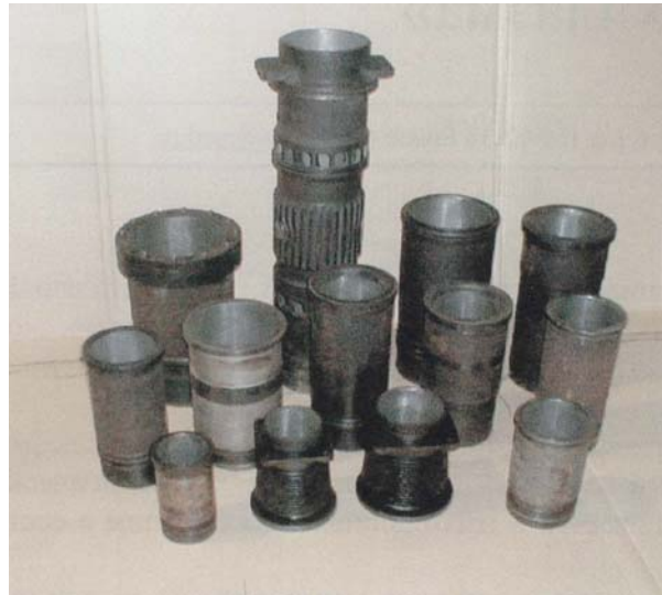
Рис. 8. Восстановленные и упрочненные локомотивные втулки
