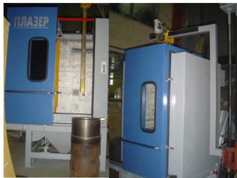
Полуавтомат для напыления покрытий на внутренние поверхности
