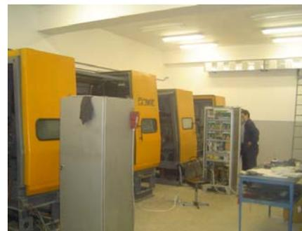
Полуавтомат для напыления покрытий на колен валы
